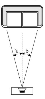
Der Lautsprecher besitzt an der Rückseite zwei Bassreflexöffnungen. Lassen Sie einen Abstand von mindestens 10 cm zwischen Lautsprecherrückseite und der Wand hinter dem Lautsprecher, um eine einwandfreie Funktion der Bassreflexöffnungen zu gewährleisten.
